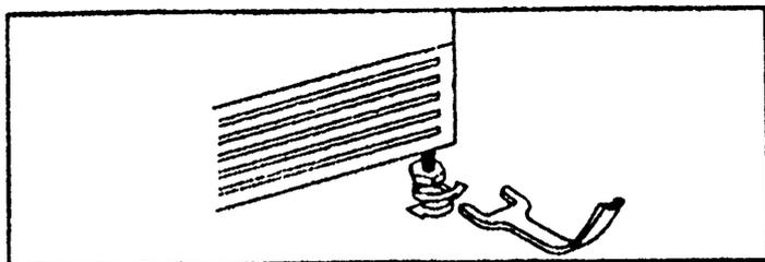
УБЕДИТЕСЬ, ЧТО НОЖКИ ОТРЕГУЛИРОВАНЫ. ИСПОЛЬЗУЙТЕ ГАЕЧНЫЙ КЛЮЧ ДЛЯ ВЫРАВНИВАНИЯ АППАРАТА И ПРЕДОТВРАЩЕНИЯ ЕГО РАСКАЧИВАНИЯ
