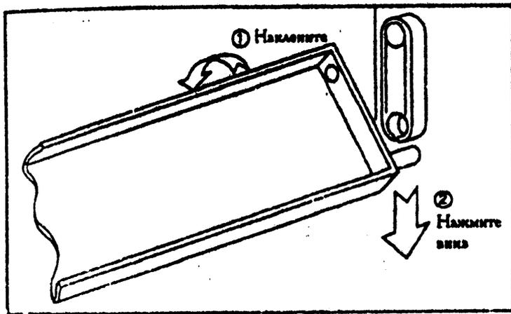
Снятие откидной створки холодильного отсека
