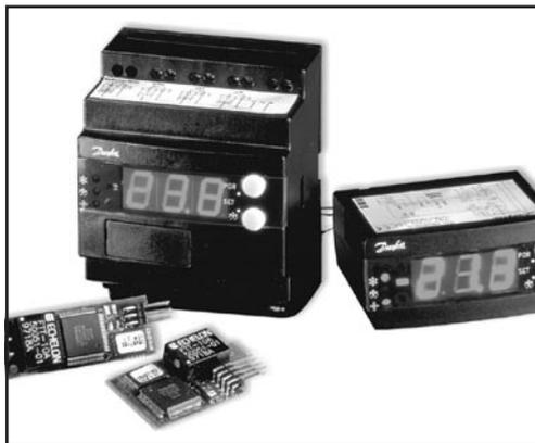
Контроллеры ЕКС 201 (для установки на панель) и ЕКС 301 (для монтажа на DIN-рейку) специально разработаны для управления работой холодильных установок таким образом, чтобы максимально возможно оптимизировать и упростить операции установки и программирования блоков. Все блоки разработаны для управления температурой в холодильных камерах открытием/закрытием соленоидного клапана или остановом/пуском компрессора.
